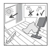
Lösung anschließend verteilen und den Bodenbelag nach kurzer Einwirkzeit mit Schrubber oder Einscheibenmaschine SRP und rotem Pad/Schrubberbürste bearbeiten. Die Schmutzflotte mit saugfähigen Breitwischmopp oder Sprühsauger mit Hartbodenadapter aufnehmen. Zum Schluss zweimalig mit klarem Wasser zur Neutralisation nachwischen.
