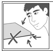
Während der Verlegung die Bahnen auf Materialfehler überprüfen. Bahnen mit sichtbaren Materialfehlern dürfen nicht verlegt werden.
