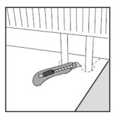
Living CV-Böden sollten grundsätzlich verschweißt werden. Dies kann mittels Kaltschweißmittel erfolgen. Decken Sie die Naht vorher mit geeignetem Klebeband ab und pressen dieses mittels einer Andrückrolle fest an. Durchtrennen Sie das Klebeband dann entlang der Naht mit einem Rollmesser. Drücken Sie die Nadel der Tube tief in die Naht hinein (Kaltschweißmittel Typ A), fahren in dieser entlang und dosieren Sie das Kaltschweißmittel so, dass eine ca. 5 mm breite Benetzung des Klebebands erfolgt.
