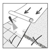
holen Sie sich hierzu die entsprechende Aufbauempfehlung von ihrem Bauchemiehersteller ein. Schwimmend verlegte Altbeläge sind grundsätzlich zu entfernen
